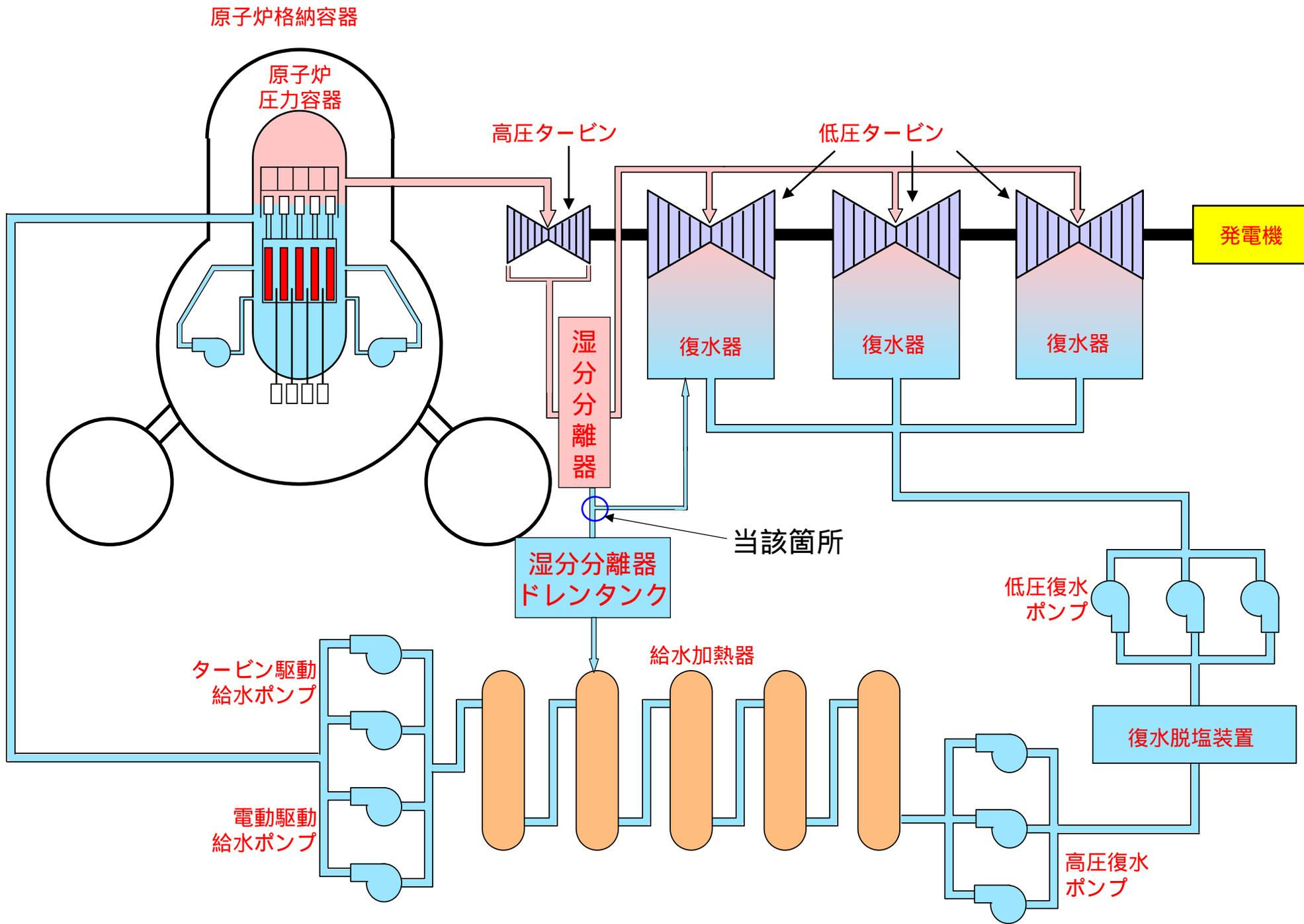
2号機主蒸気・給復水系統概要図
