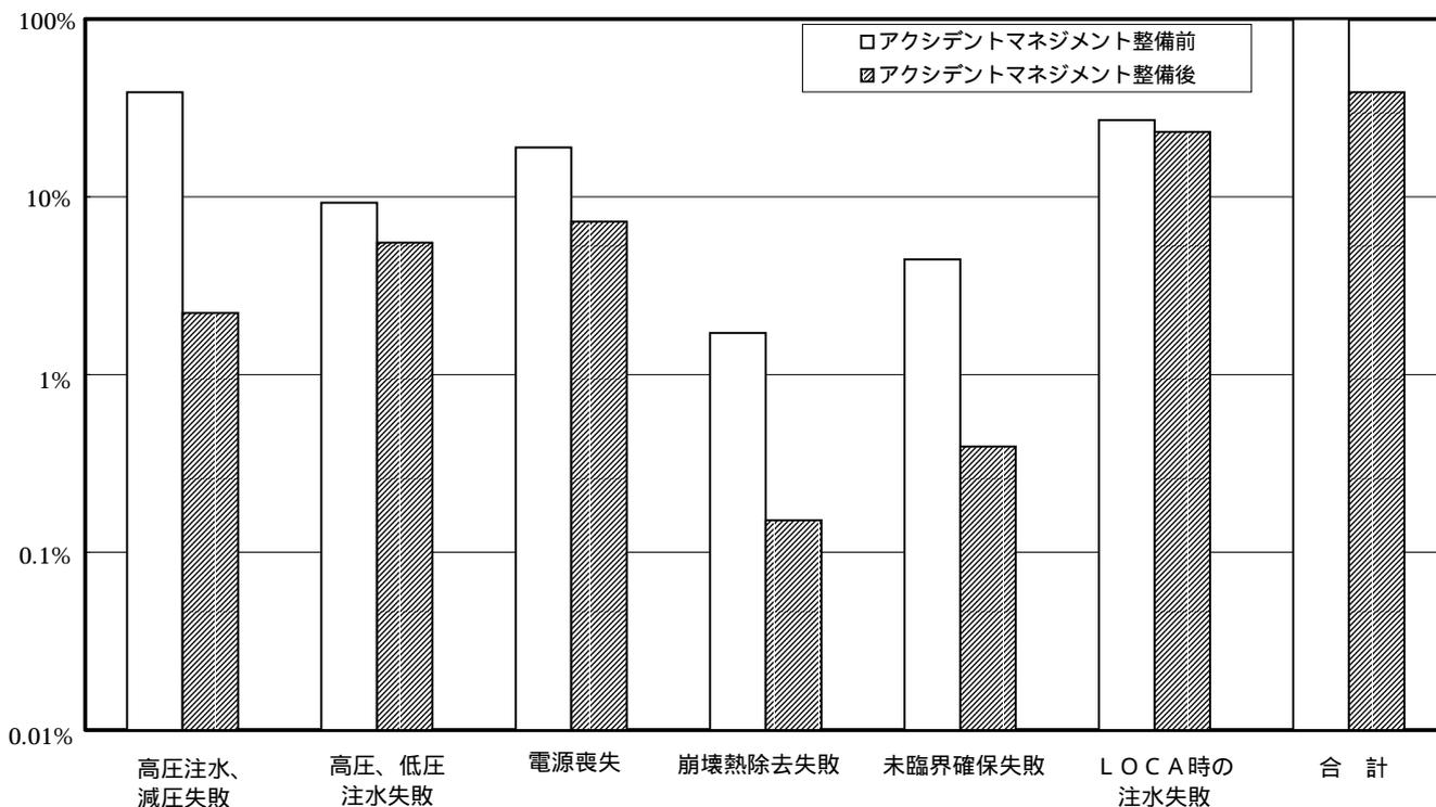
炉心の健全性に関する確率論的安全評価(レベル1 P S A )結果 ( 福島第一3号炉 BWR4 )
