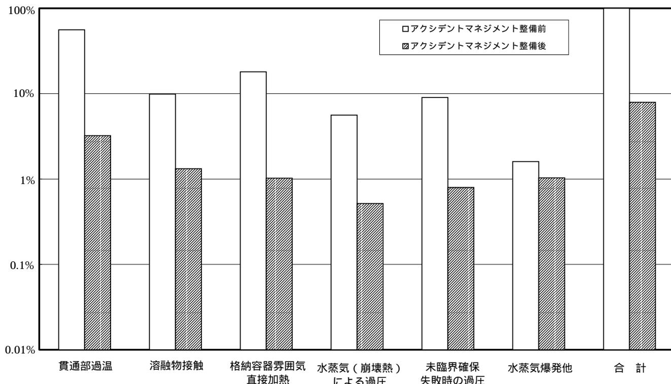
格納容器の健全性に関する確率論的安全評価(レベル2 P S A )結果 ( 福島第一3号炉 BWR4 )
