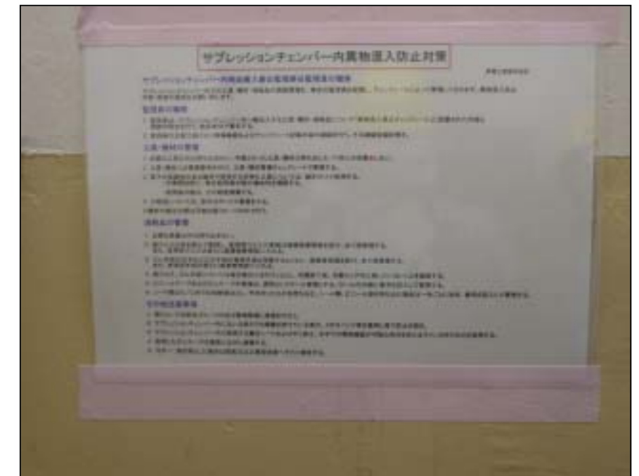
2F - 2 圧力抑制室入口での異物混入防止の周知徹底
