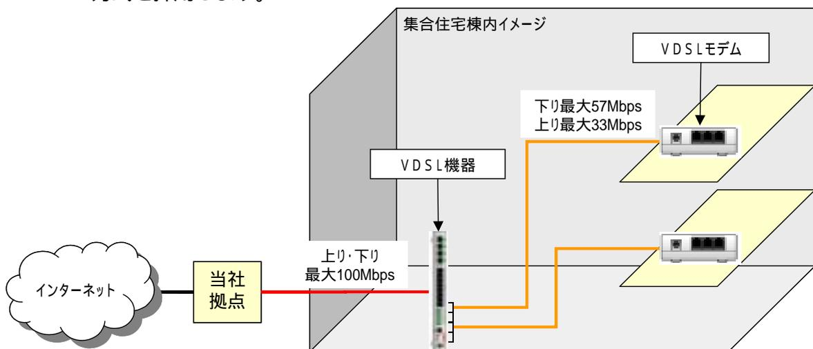
図.「マンションタイプ」設備構成図
