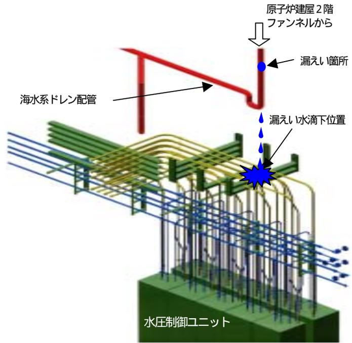
原子炉建屋1階水圧制御ユニットのBブロック上部の位置関係図
