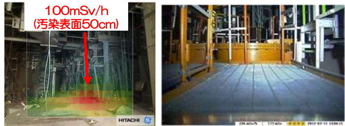
ガンマカメラによる大物搬入口付近撮影(H24/6/11~15)
