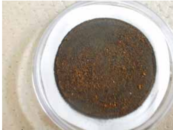
バッファタンク水(8Lろ過) ろ過後の質量増加: 約0.06g
