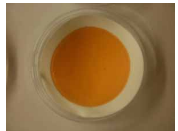
RO処理水(6Lろ過) ろ過後の質量増加: 0.01g以下
