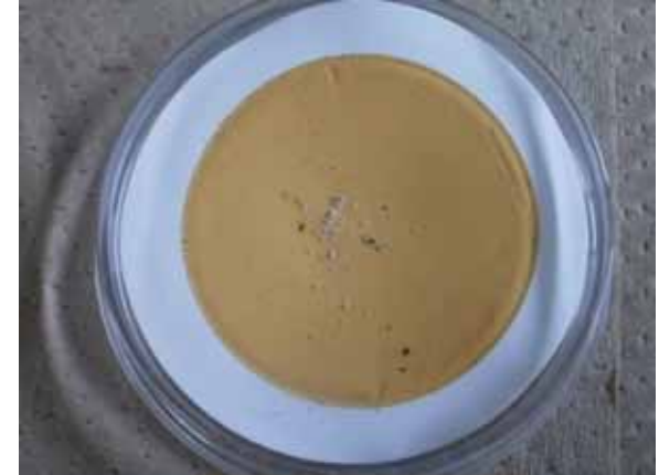
RO処理水(6Lろ過) ろ過後の質量増加: 0.01g以下
