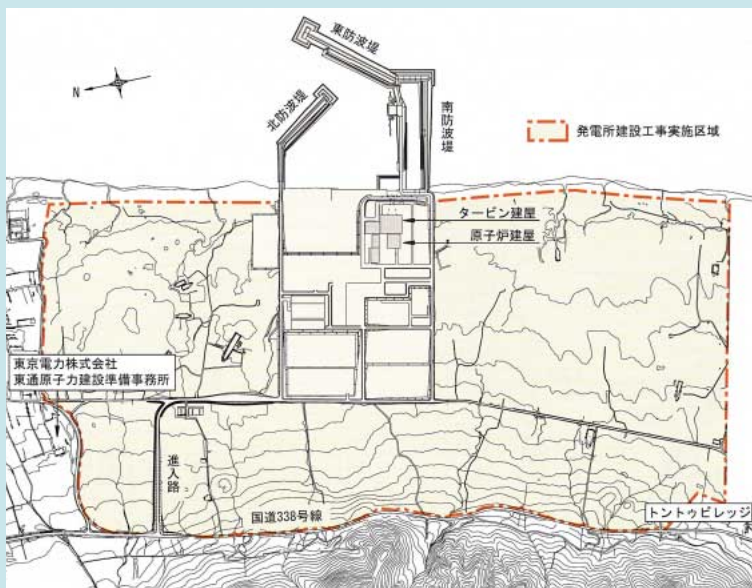
東通原子力発電所1号機 建設計画平面図
