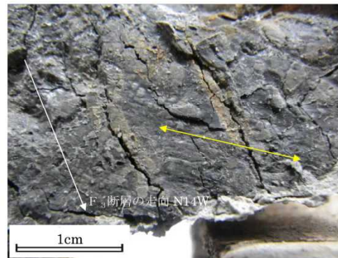
F 3 断層②の条線 (黄色矢印方向)
