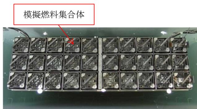
(2) 供試体の水槽内設置状況
