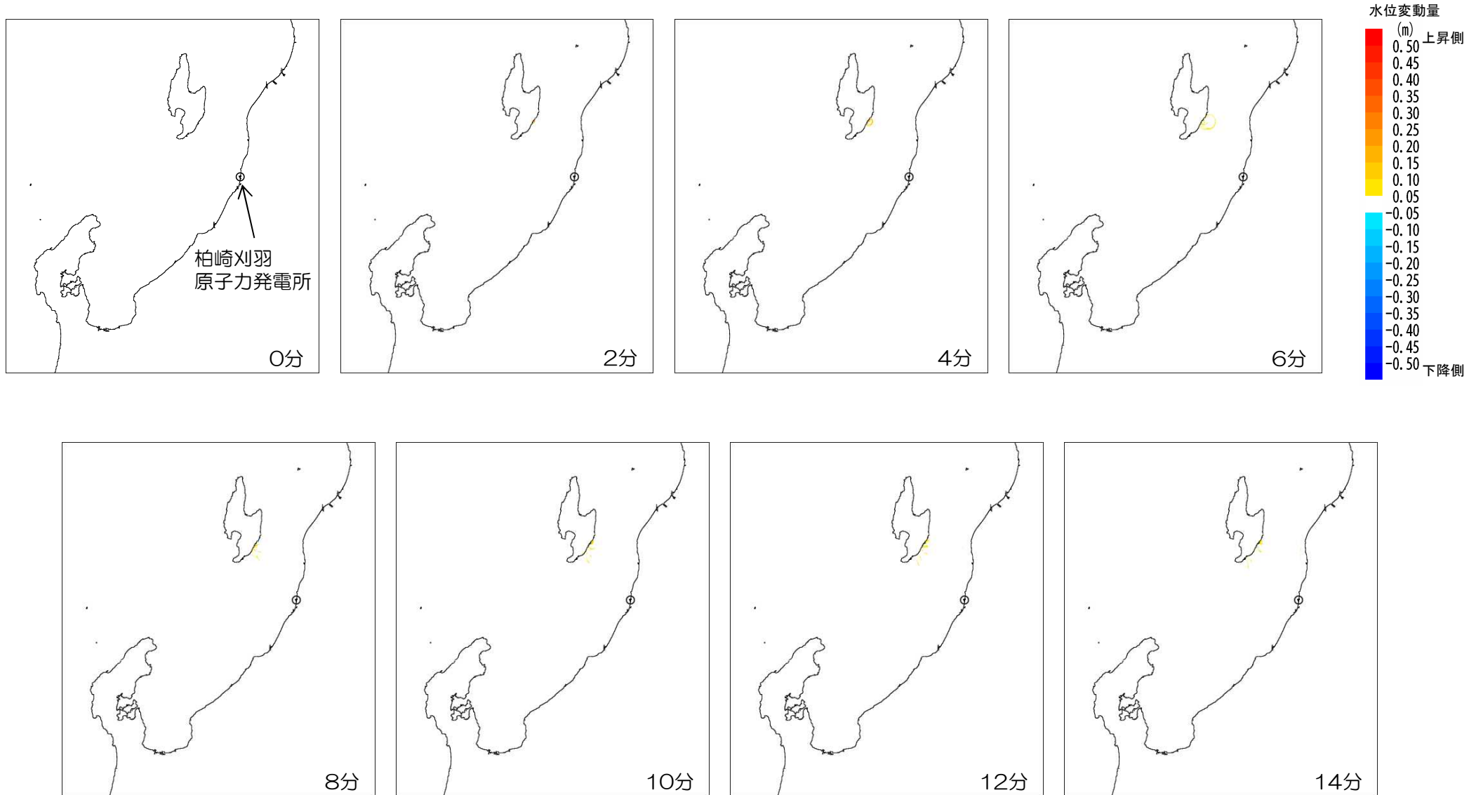
■二層流モデルに基づく手法による津波水位の経時変化 SD-2,3同時 (0分~14分)
