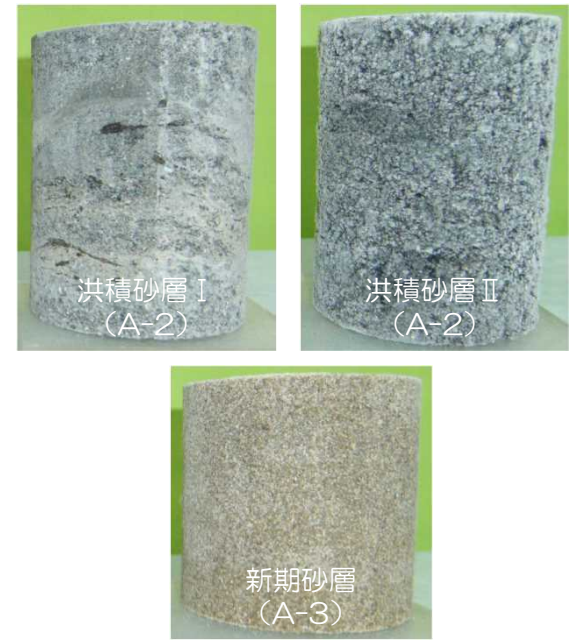
図 試験供試体例 (左上：洪積砂層 I 右上：洪積砂層 II 下：新期砂層・沖積層 )
