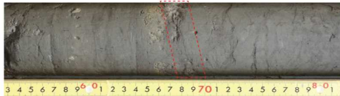
F5-4 孔の掘削深度 37.67m に、レンズ状の細粒火山灰が分布する。
