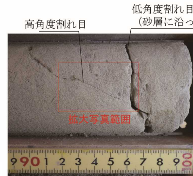
F5-11 孔 掘削深度25.85~26.00m写真
