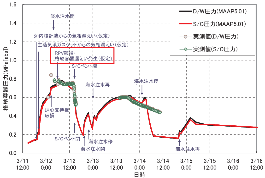
図 10-1 1号機 格納容器圧力挙動
