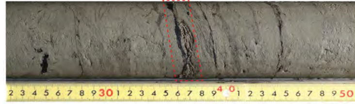
F5-2 孔の掘削深度 37.37m に、レンズ状の細粒火山灰が分布する。
