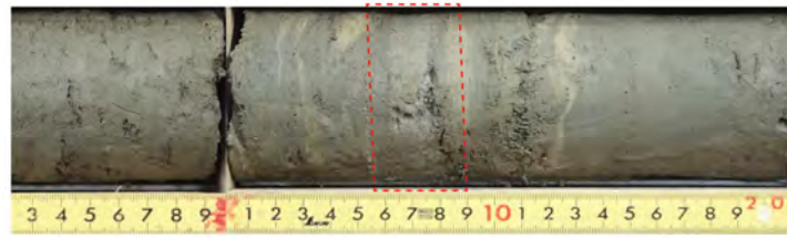
F5-1 孔の掘削深度 20.08m に層厚 20mm の細粒火山灰が分布する。
