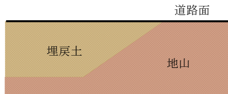
図24 地山と埋戻部の境界の状況
