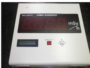
図 2.7-1 可搬型エリアモニタ外観
