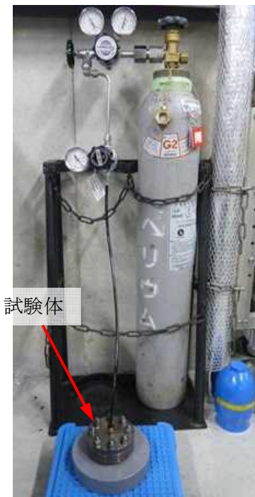
図5 He気密確認試験状況
