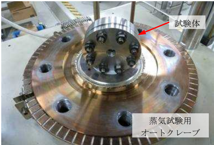
図 4 蒸気暴露試験体設置状況
