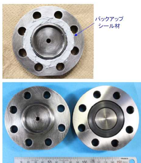
図4-19 「改良EPDM+バックアップシール材」組合せ試験装置
