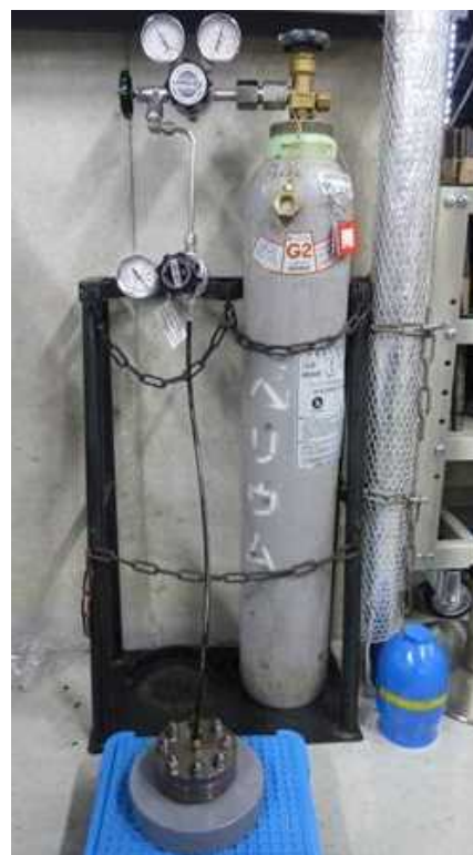
図 12 He 気密確認試験状況
