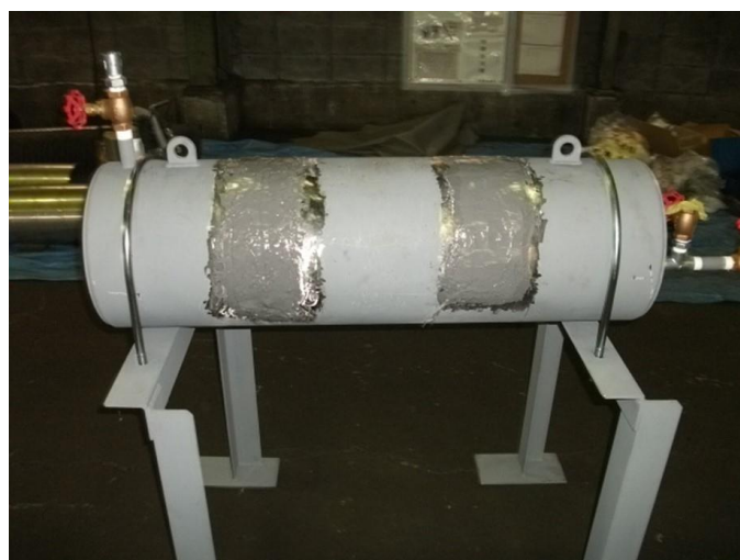
図 2.1.2-6 ベロメタル補修後の耐圧試験概要
