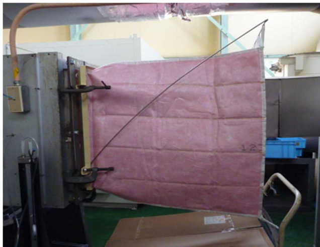
図 7-2 バグフィルタの耐荷重試験の様子
