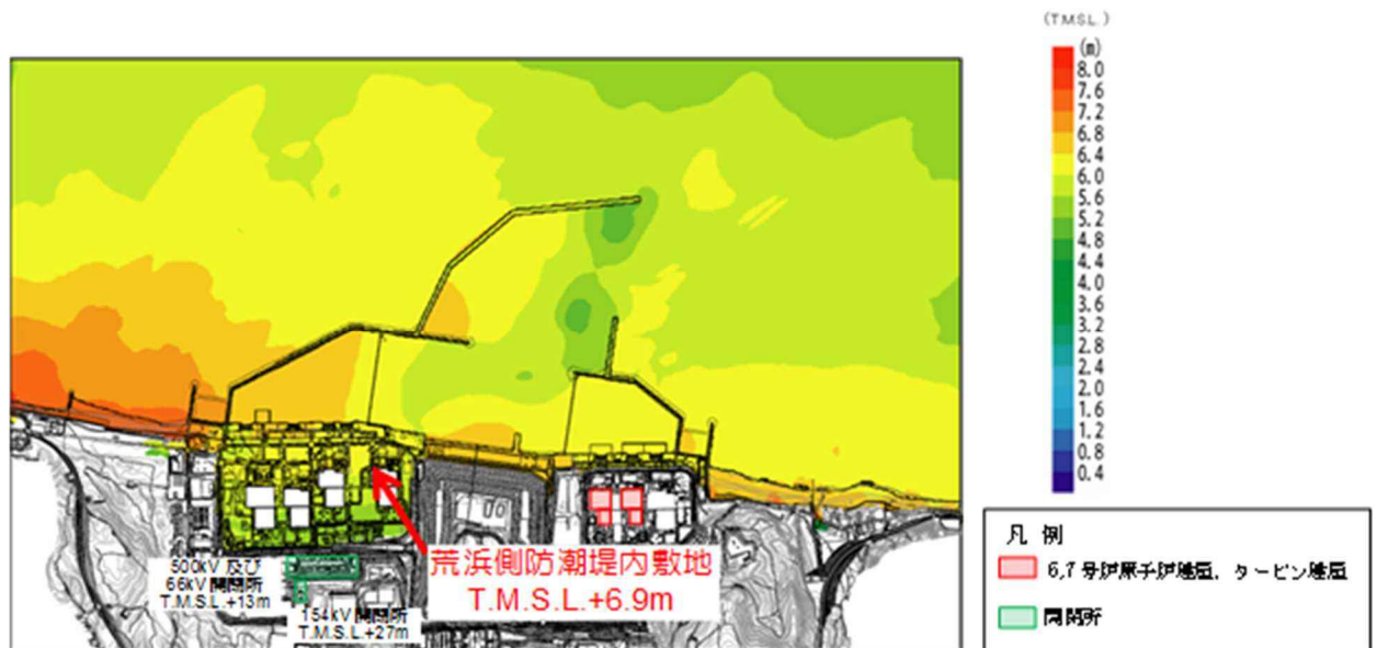
第2.2.4-40図 柏崎刈羽原子力発電所の敷地高さと各施設との関係
