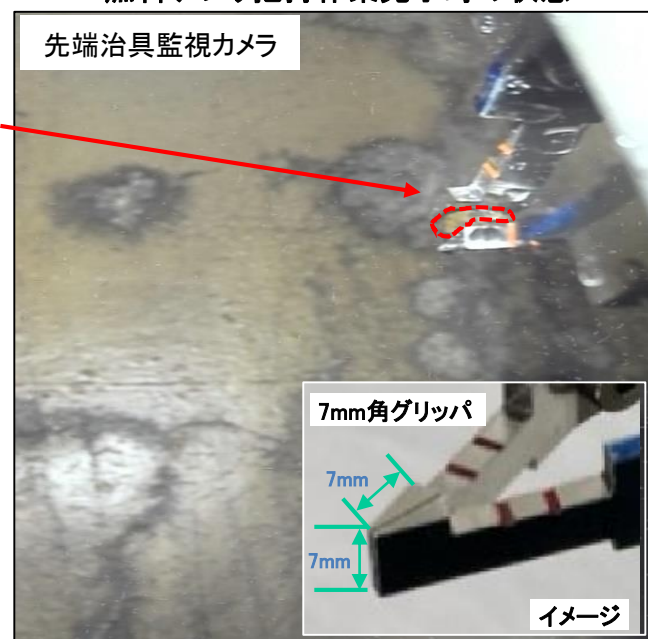
燃料デブリ把持作業完了時の状態
