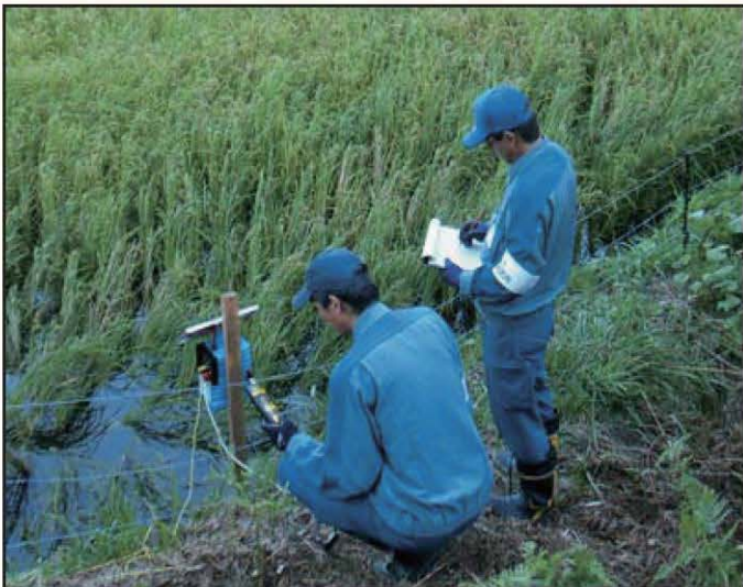
電気柵の電圧測定【平成25年9月17日】
