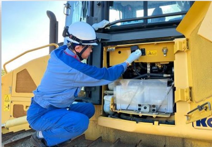
ブルドーザーの外観点検
