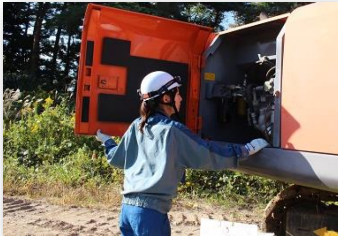
バックホーの外観点検
