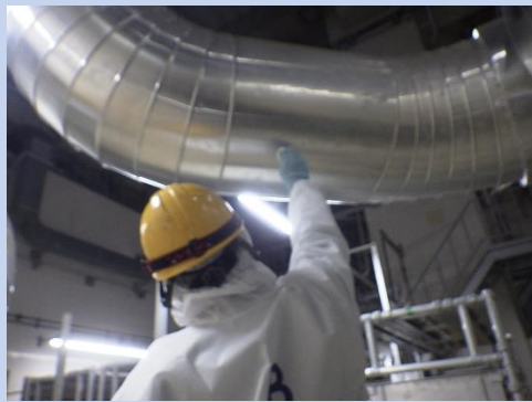
スミア*3法による 表面汚染密度測定
