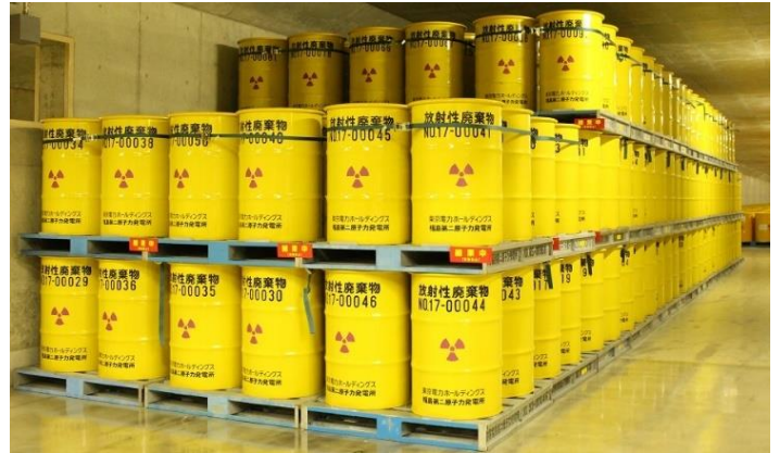
固体廃棄物貯蔵庫内に保管されている放射性固体廃棄物
