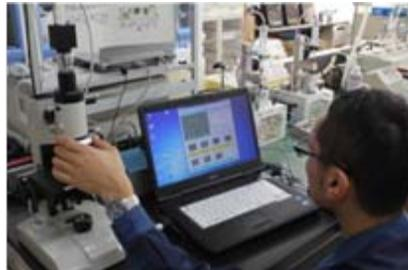
採取した潤滑油の状態を顕微鏡を使い確認している様子
