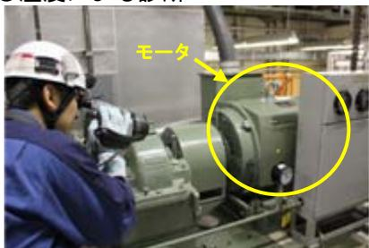
赤外線サーモグラフィカメラでモータの温度を測定している様子
