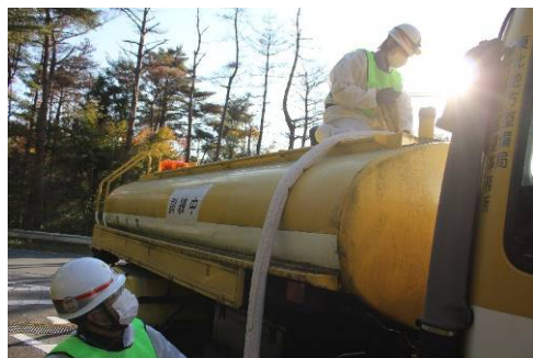
給水車上部からの給水
